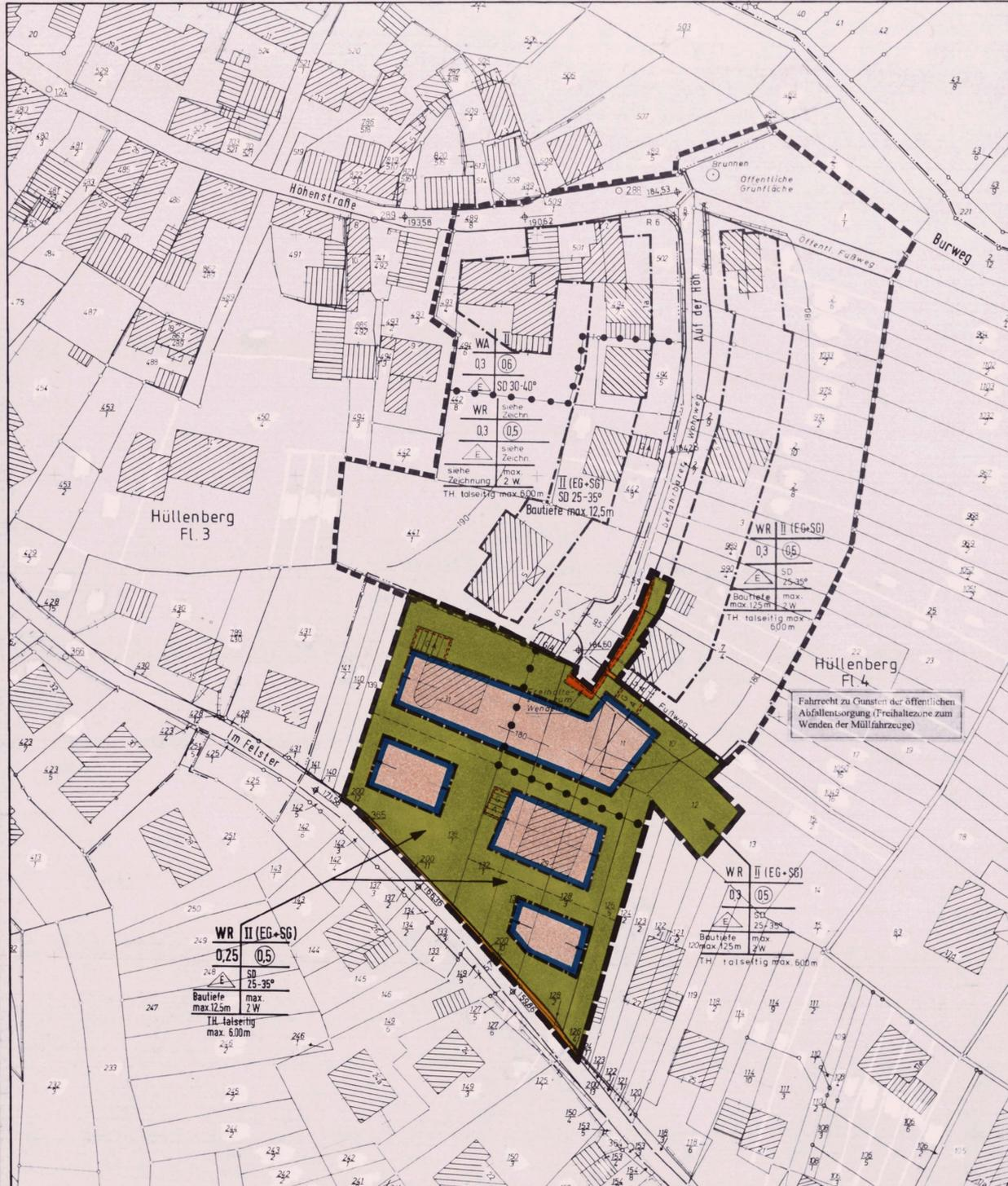
Zeichenerklärung: 1. Art der baulichen Nutzung (§ 9 Abs. 1 Nr. 1 BauGB) - WR reines Wohngebiet / überbaubare Fläche (§ 3 Bau NVO) ... 2. Maß der baulichen Nutzung (§ 9 Abs. 1 Nr. 1 BauGB) - 0,5 Geschossflächenzahl, 0,3 Grundflächenzahl ... 3. Bauweise, Baulinien, Baugrenzen (§ 9 Abs. 1 Nr. 2 BauGB) ... 4. Verkehrsflächen (§ 9 Abs. 1 Nr. 11 und Abs. 6 BauGB) ... 5. Grünflächen (§ 9 Abs. 1 Nr. 15 und Abs. 6 BauGB) ... 6. Sonstige Planzeichen ...
